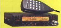
YAESU FT-5100 Veicolare bibanda, 50W, duplexer interno, ricezione V&V/U&U, full duplex, 46 memorie
