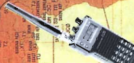
IC 101 - Ricevitore di ridottissime dimensioni per ricezione da 100kHz a 1300 MHz
