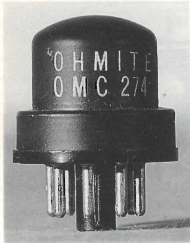
foto 4 - Primo piano della "valvola allo stadio solido".
