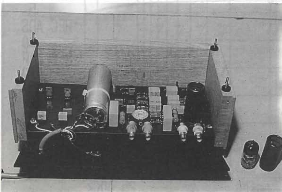
figura 2 - "Esploso" e vista ravvicinata. Si noti l'esemplare pulizia del cablaggio (CS in vetronite a 2 layer) e la qualità dei componenti impiegati.
